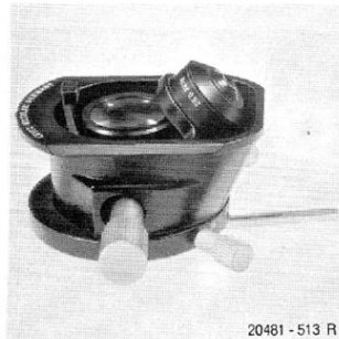
Abb. 36 Zentrierbarer Systemkondensator mit ausgeklapptem Kondensorkopf. Man erkennt die große Beleuchtungslinse im Unterteil, die für Objektive geringer Apertur benutzt wird.
